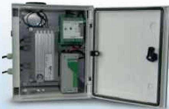
Estación de aforo para aguas superficiales; conexión a la red con batería tampón, registro de valores medidos en intervalos de minutos, transmisión de datos en intervalos de 15 minutos; además, la transmisión de datos se conmuta automáticamente a 5 minutos si se superan los valores límite.
